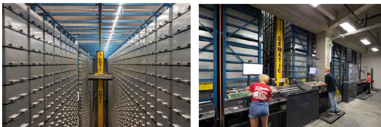
Рис. Г.3. Система сортування та зберігання документів в бібліотеці Чарльза Університету Темпл, США (Charles Library at Temple University) [171]
