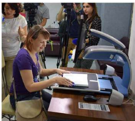
Рис. Г.5. Інклюзивні технології та засоби доступності у бібліотечних просторах: а) тактильна плитка та використання поверхневих кольорів; б) таблички написані шрифтом Брайля; в) пристрій, що переводить надрукований текст в аудіоформат; г) спеціальне програмне забезпечення для синтезу мовлення [156]
