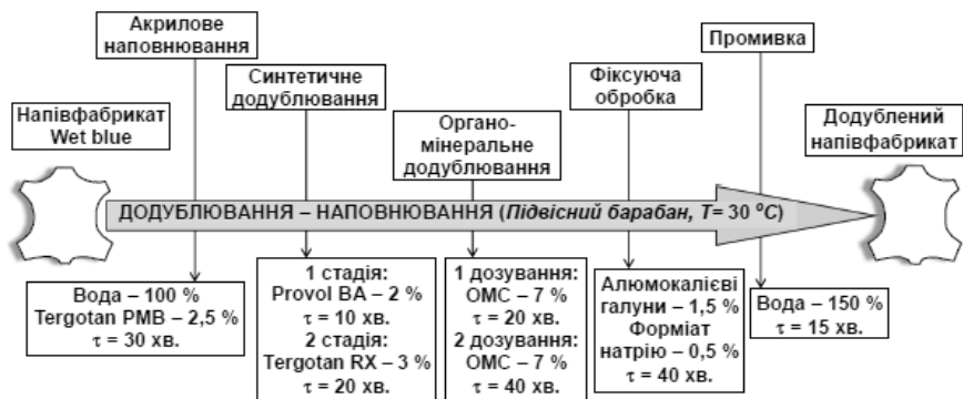
Рис. 3.23. Технологічна схема додублювання-наповнювання шкіряного напівфабрикату ОМК
