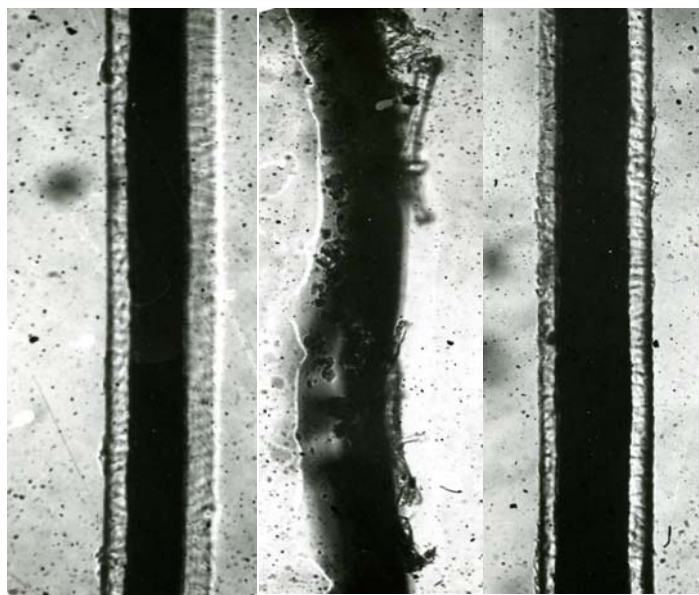
Рисунок 1.11 – Знежирений волос (1), оброблений сульфідом натрію з попередньою імунізацією його стержня гідроксидом кальцію (2) і те саме за наявності формальдегіду (3)
