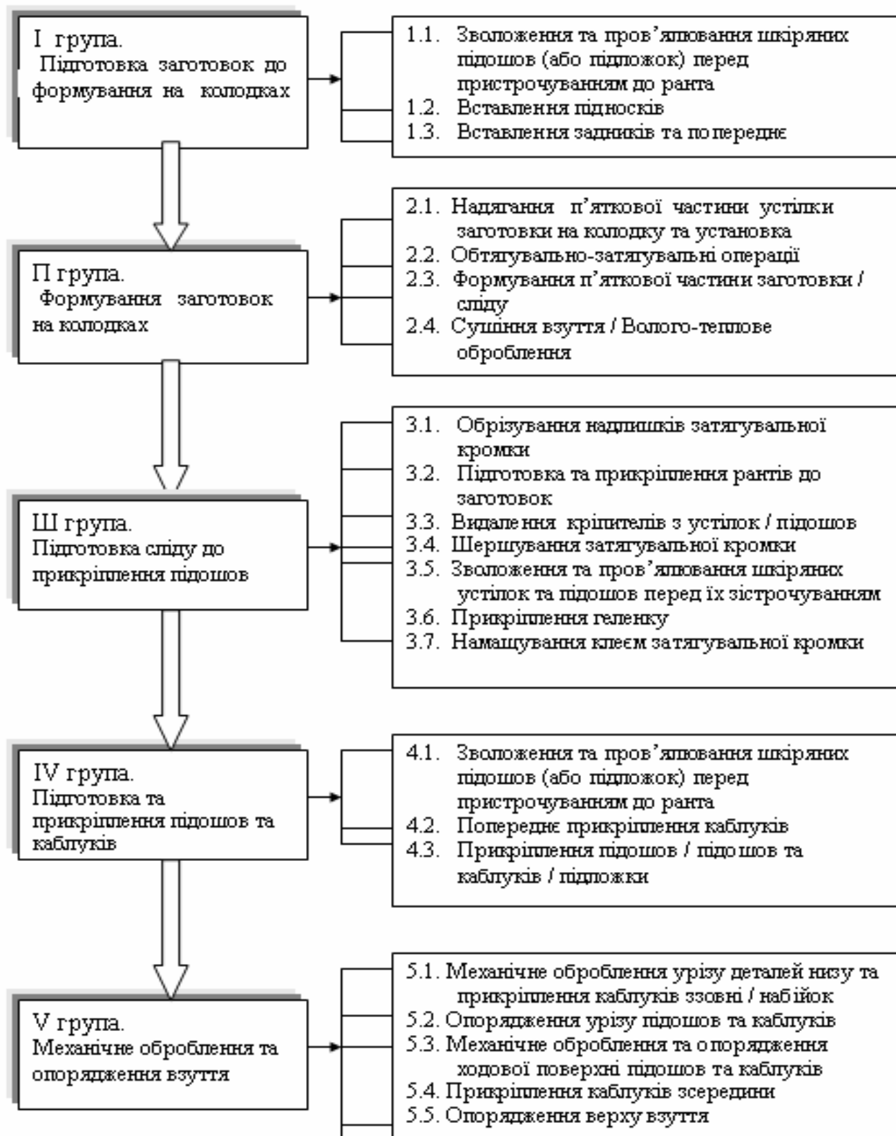
Рисунок 5.5 – Структурна модель технологічного процесу складання взуття різних методів кріплення за модульним принципом
