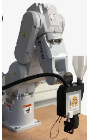
Рис.4. Пелетний екструдер Direct 3D
