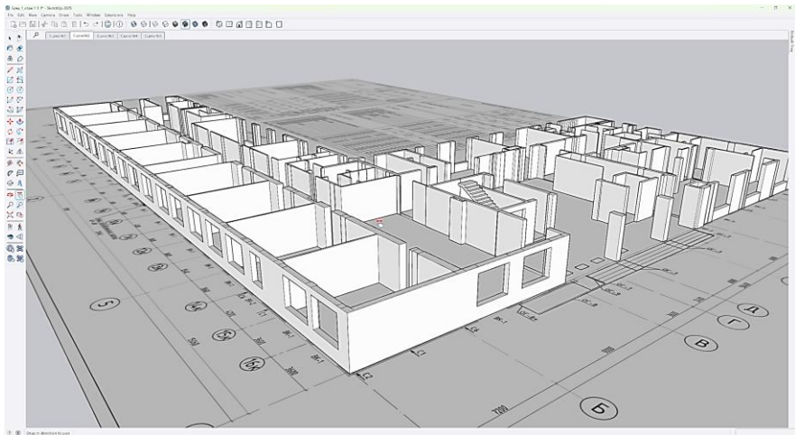
Рис. 3. Зведення стін, віконних та дверних отворів першого поверху будинку інструментом «Видавиту/Витягнути»
